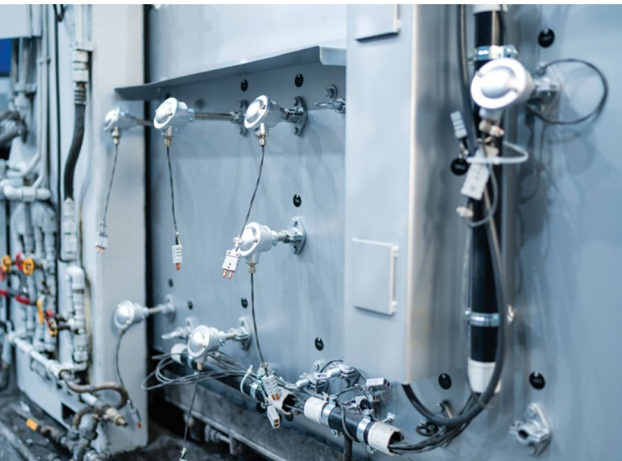
Messkonzept am Bivalenten Tiegelofen.
