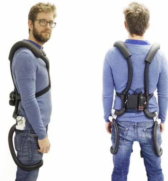
**ErgoJack in Seitenansicht mit arretierbarem Hüftgelenk und Beinbügel (links) und von hinten, mit Akku und Recheneinheit (rechts)**
